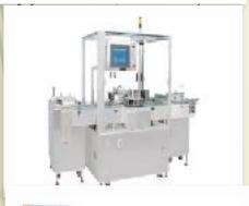
LINEAR VIAL/BOTTLE LABELER(CYLINDRICAL SHAPE OBJECT)
