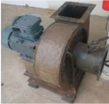
CENTRIFUGAL BLOWER (MS + FRP)
