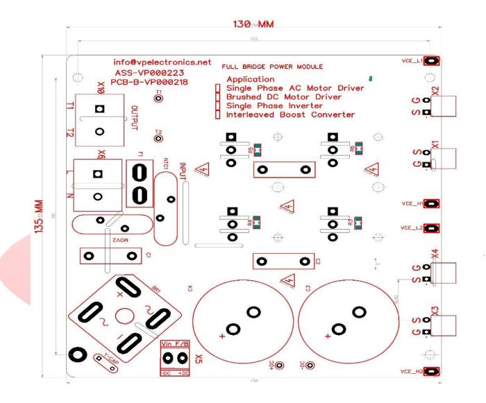
**2 LEG 2 LEVEL INVETER STACK 2.4KW**
