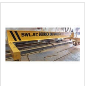
5 Ton SG Eot Crane
