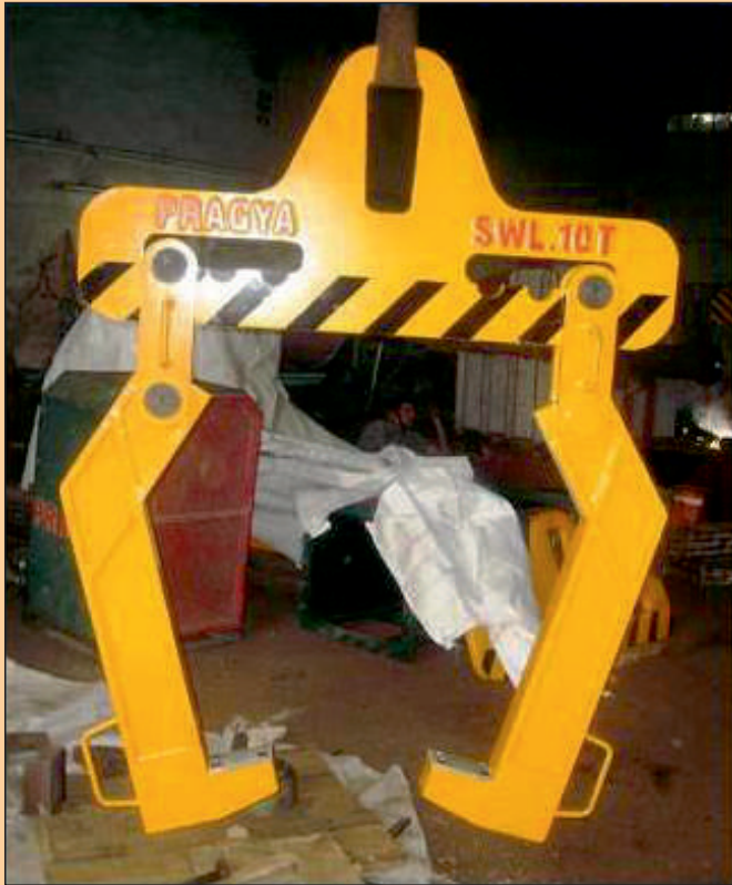
SLAB TONG CAP. 45 TON
