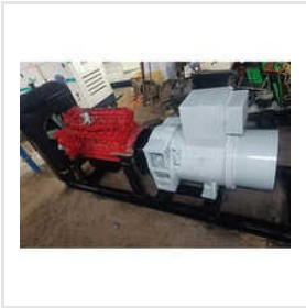
20 KVA Biogas Generator
