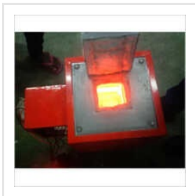
Non Ferrous Furnace
