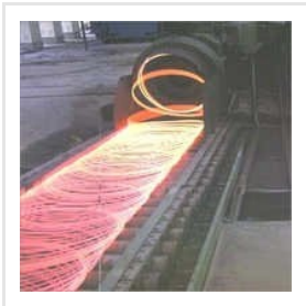
Wire Rod Rolling Mill
