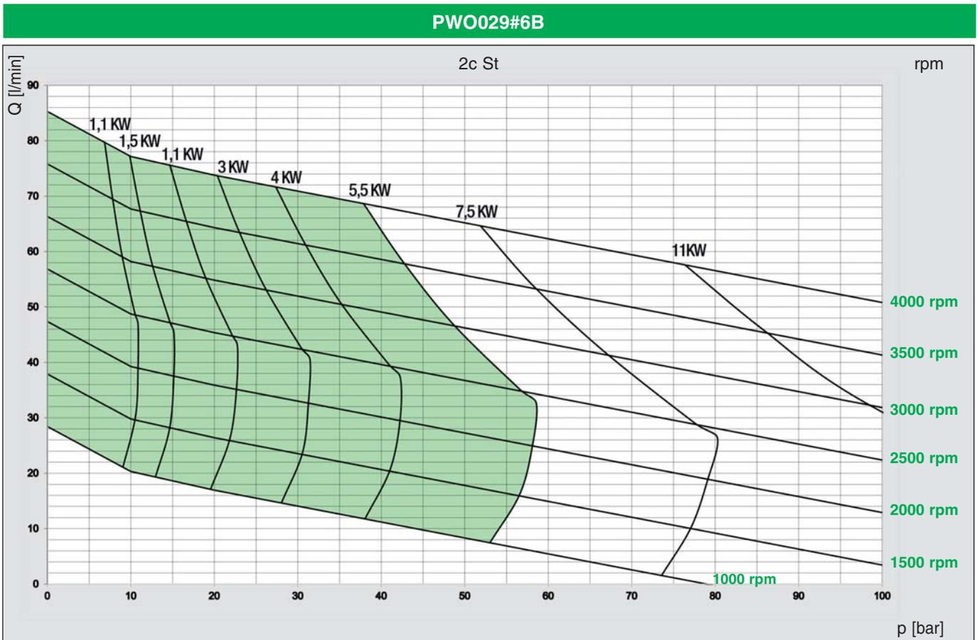
L'area in verde del presente diagramma indica che qualsiasi condizione di pressione e portata è ottenibile in termini di coppia e potenza motore. In caso di più punti di lavoro all'interno dell'area, la potenza del motore è ottimizzata di conseguenza.
