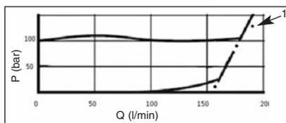
"1" è la curva della pressione minima tarabile (fino a 100 l/min, la pressione minima tarabile è <10 bar, a 150 l/min 20 bar).
