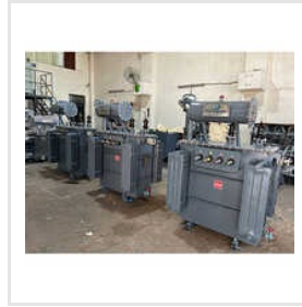
250 Kva AL Level-II Transformer
