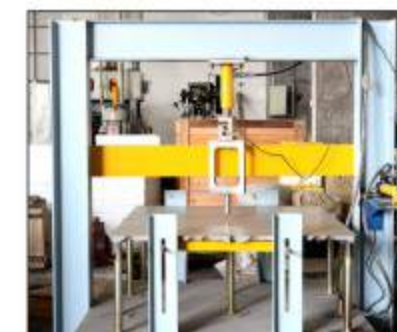
Design Load Test 设计压力载荷测试
