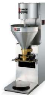
自动型肉丸成型机 (生产效率: 230kg/小时) Automatic meat ball forming machine
