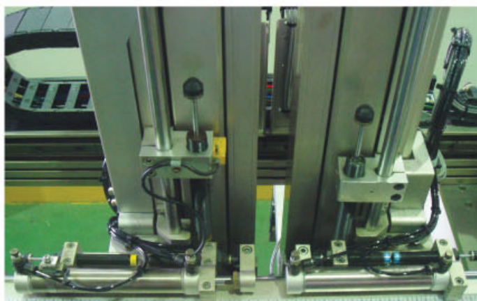
CEC SHOCK ABSORBERS USING IN ROBOT PICKER CEC緩衝器使用於機器手臂
